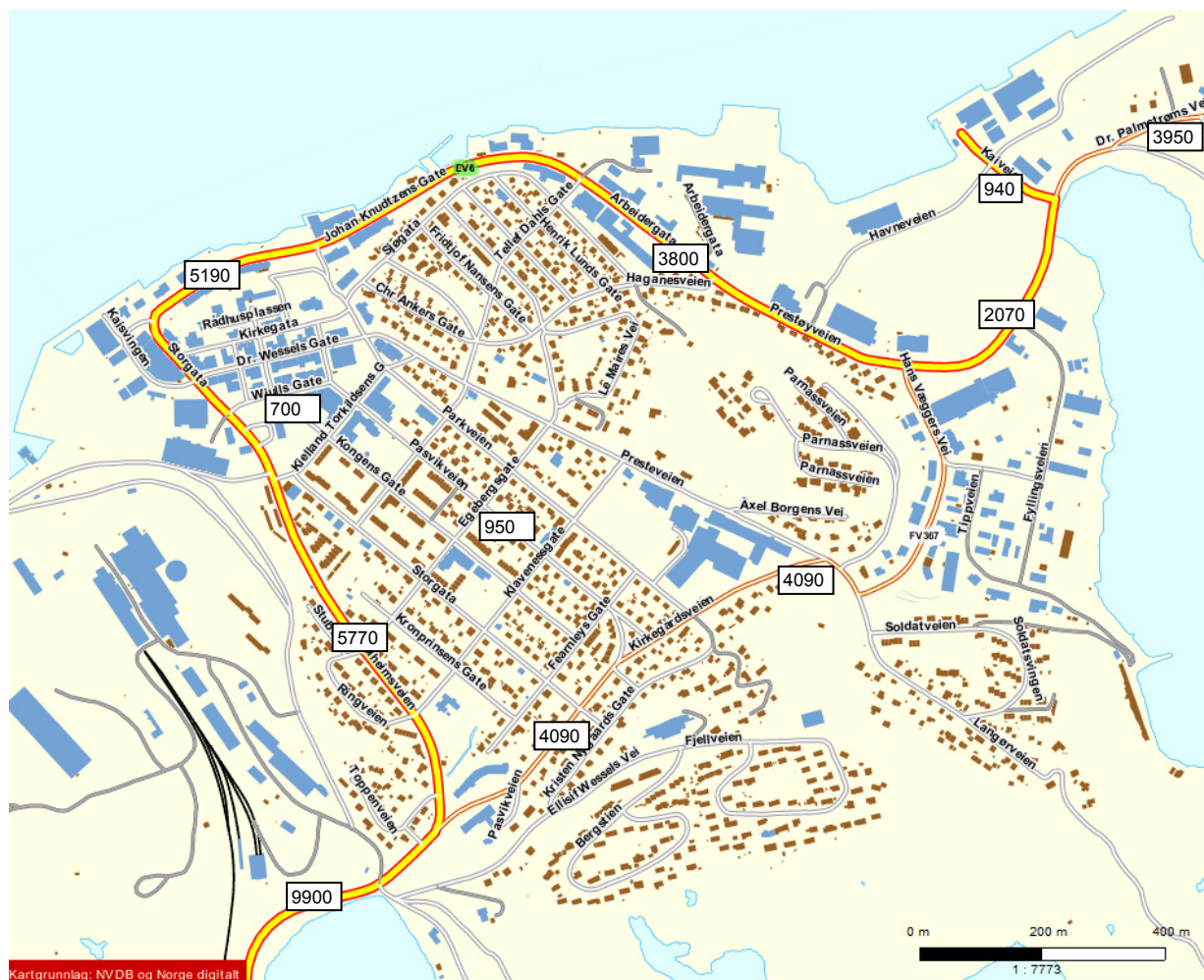
Figur 4. Oversiktskisse for årsmidla trafikk [køyretøy/døgn] langs hovudvegane i Kirkenes. Framskrivinga til prognosesituasjonen i denne rapporten er, for hovudvegane, gjort ved å leggja til grunn utviklingsbanen «middels vekst» i transportanalysen frå 2011. For resterande veglekkjer og der transportanalysen ikkje er detaljert nok er det brukt dagens årsmidla trafikk pluss 40 %.
