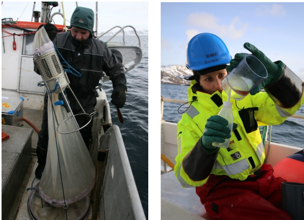
Figur 2. Prøvetaking av zooplankton i Bøkfjorden ved bruk av WP-2 plankton håv (200 \mu m). Foto: Geir Dahl-Hansen, Akvaplan-niva.
